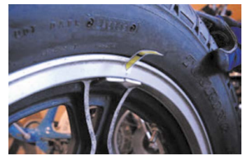
Рисунок 10 – Определения тяжёлой точки колеса
