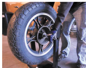
Рисунок 8 – Установка вала с колесом
