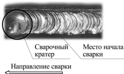
Рис. 7.4. Начало сварки при смене электрода.
